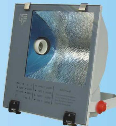
Načinom izrade kućišta, (livenjem aluminijuma pod pritiskom) i površinskom zaštitom koja je izvršena procesom plastifikacije čini ovaj reflektor otpornim na atmosferske uticaje, što omogućuje njegovu unutrašnju i spoljašnju upotrebu.
