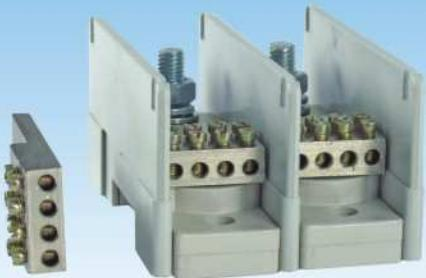
Koristi se za šemiranje mernih i razvodnih ormana. Kućište je izrađeno od visoko kvalitetnih uvoznih plastičnih masa, samogasivosti V-0 i odpornost na zagrevanje 110°C bez deformisanja. Kontakti su izrađeni od mesinganih profila koji omogućavaju istovremeno spajanje bakra i aluminijuma.
