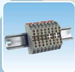
Koristi se za šemiranje mernih i razvodnih ormana. Kućište je izrađeno od visoko kvalitetnih uvoznih plastičnih masa samogasivosti V-0. Kontakti su izrađeni od mesinganih profila koji omogućavaju istovremeno spajanje bakra i aluminijuma. Podnožje stezaljke je tako konstruisano da se može nizati na sve vrste postojećih šina.
