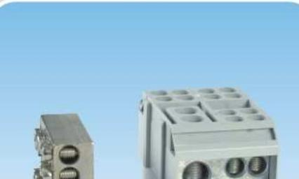
Koristi se za šemiranje mernih i razvodnih ormana. Kućište je izrađeno od visoko kvalitetnih uvoznih plastičnih masa, samogasivosti V-0 i odpornost na zagrevanje 110°C bez deformisanja. Kontakti su izrađeni od mesinganih profila koji omogućavaju istovremeno spajanje bakra i aluminijuma.
