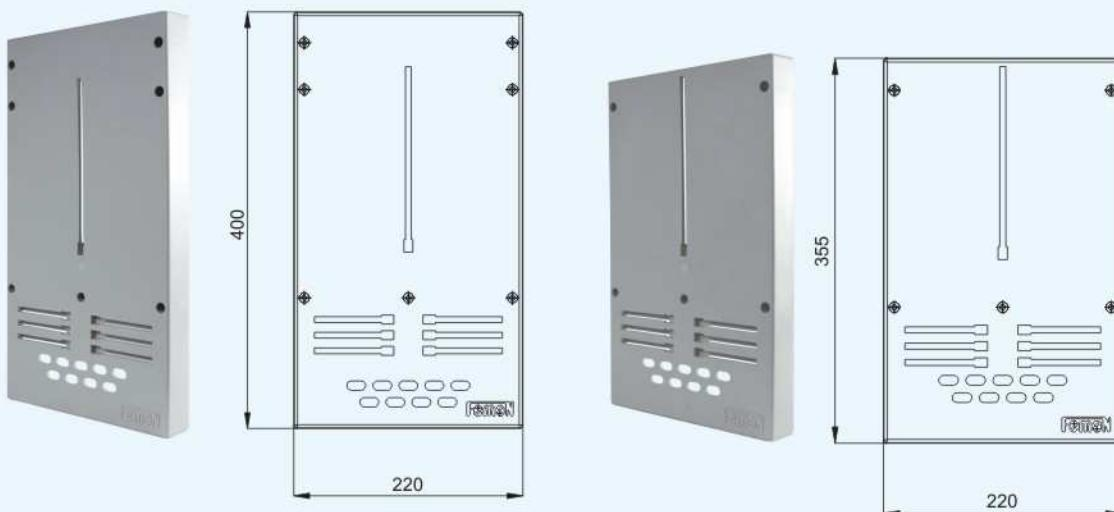
Izrađuje se od visoko kvalitetnog, samogasivog izolacionog materijala. Pričvršćuje se za kućište mernog razvodnog ormana sa četiri zavrtnja u uglovima i sigurnosnim petim zavrtnjem ispod poklopca brojila. Tabla je konstuisana tako da je brojilo podesivo po visini, i samim tim omogućava montažu za sve tipove brojila. Na tabli postoje otvori za pojedinačno uvođenje provodnika.
